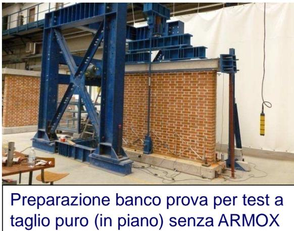
Preparazione banco prova per test a taglio puro (in piano) senza ARMOX
