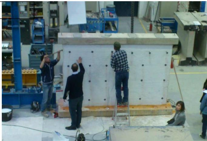
Inserimento ancoraggi anti-instabilità geometrica
