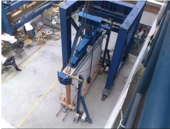
Preparazione banco di prova per test a taglio puro (in piano) con ARMOX
